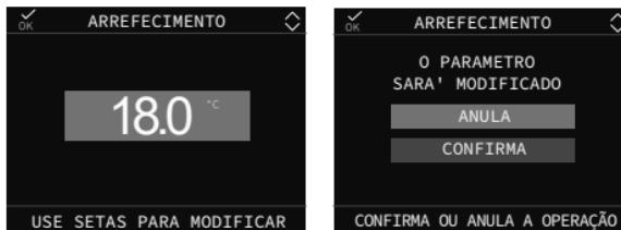
Quando o ajuste da temperatura de refrigeração é ativado, o valor da temperatura de entrega é selecionado automaticamente pelo sistema, que ajusta rapidamente a temperatura ambiente de acordo com as variações da temperatura externa.
